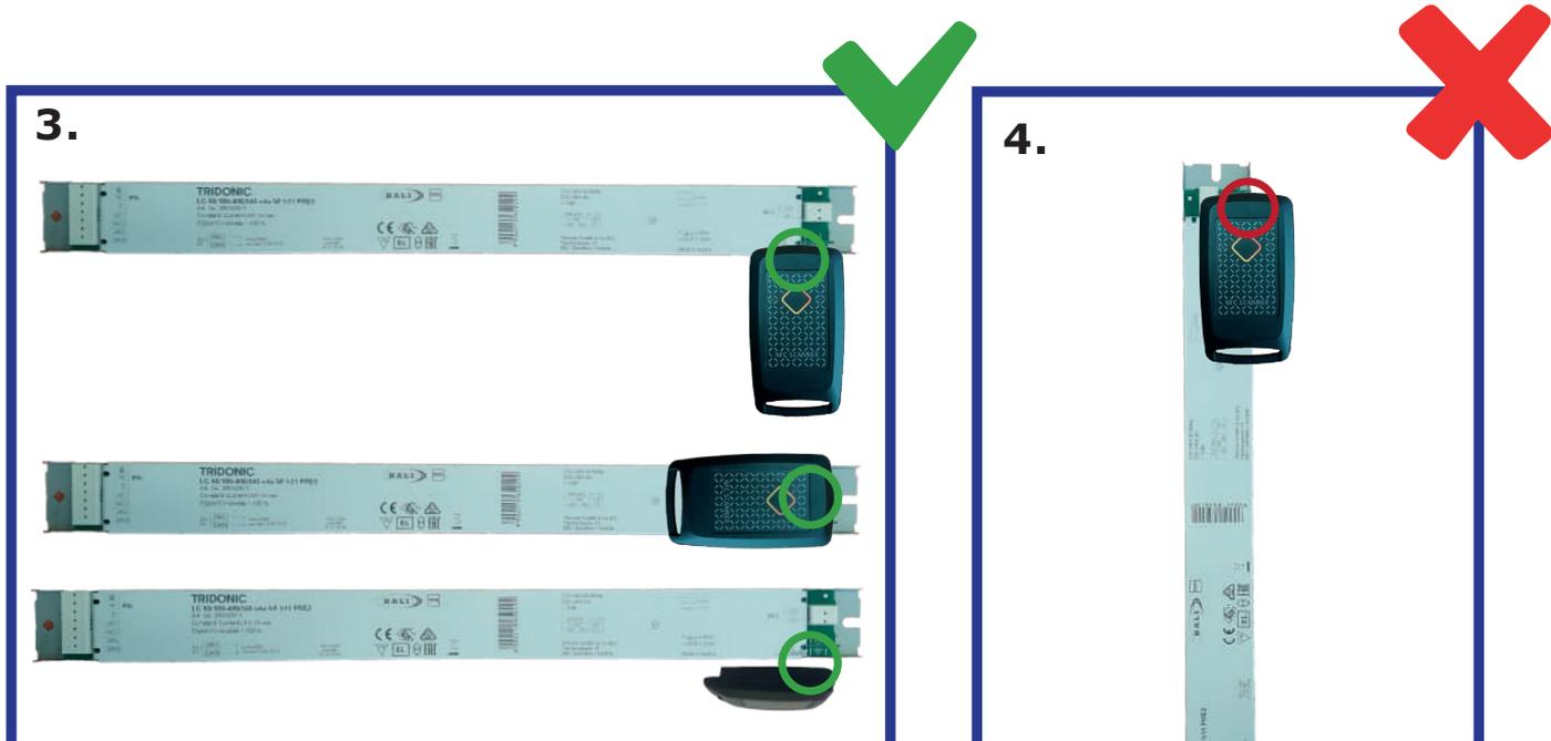
Per una lettura ottimale del driver LED, l'NFC Scanner deve essere posizionato ad angolo retto rispetto al driver LED, o in "edge reading", o lateralmente rispetto all'area NFC come mostrato in figura 3.
