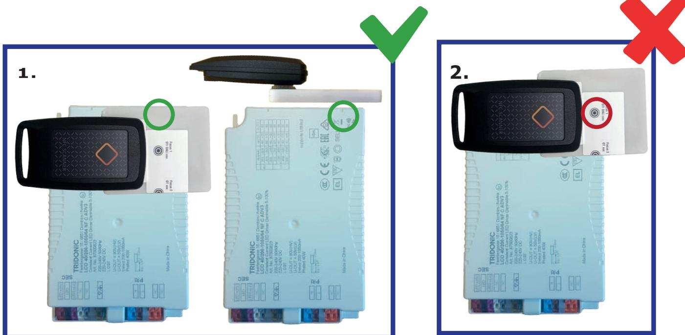
Per una lettura ottimale del driver, l'NFC Scanner deve essere posizionato in modo che il bordo dell'NFC Passive Repeater coincida con i bordi del driver LED, in corrispondenza con "Focus 2" riportato sull'etichetta apposta sull'NFC Passive Repeater. Oppure si posiziona di lato al driver LED. Vedere **figura 1**.
