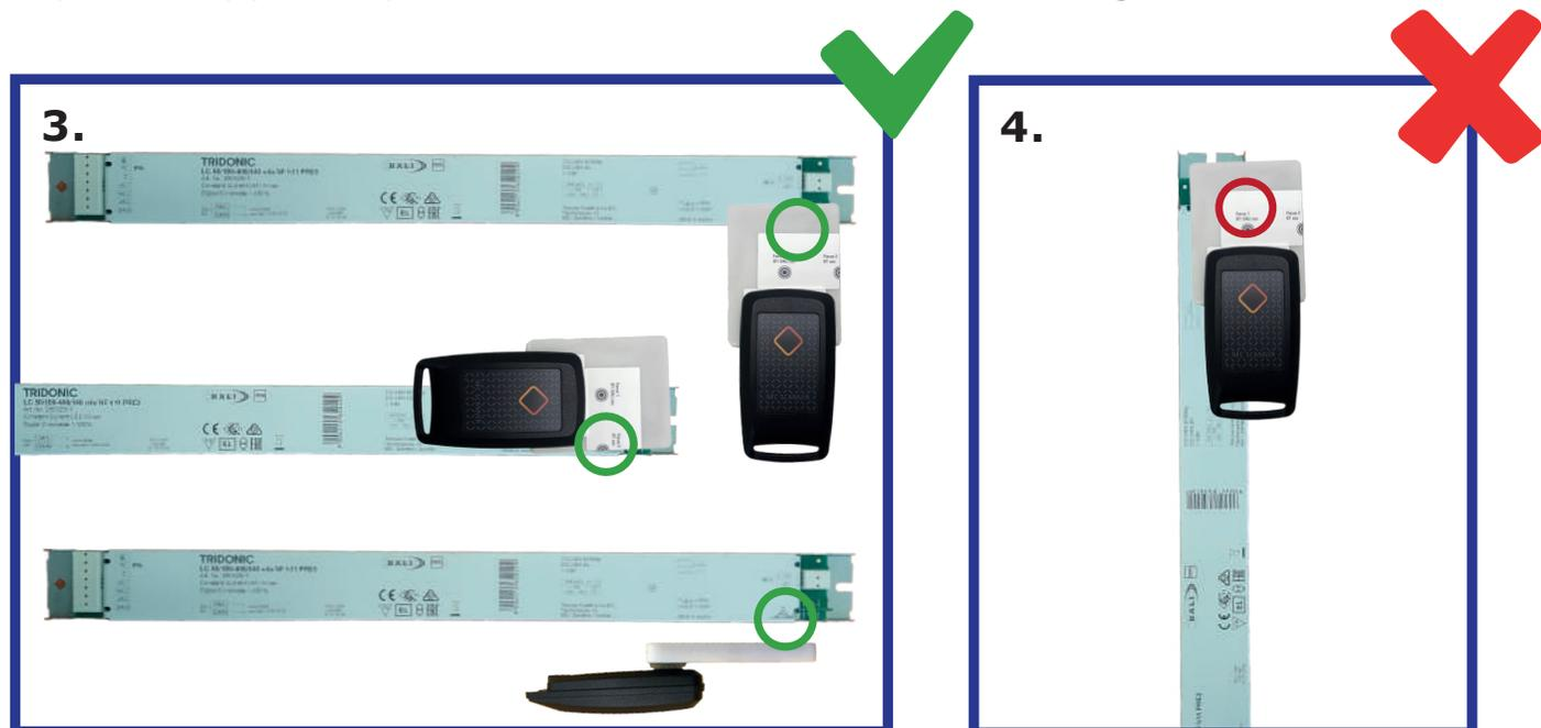
Per una lettura ottimale del driver LED, l'NFC Scanner deve essere posizionato ad angolo retto rispetto al driver LED, in modo che il bordo dell'NFC Passive Repeater coincida con il bordo del driver LED. O in modo che il bordo dell'NFC Passive Repeater coincida con i bordi del driver LED, in corrispondenza con "Focus 2" riportato sull'etichetta. Oppure si posiziona di lato al driver LED. Vedere **figura 3**.
