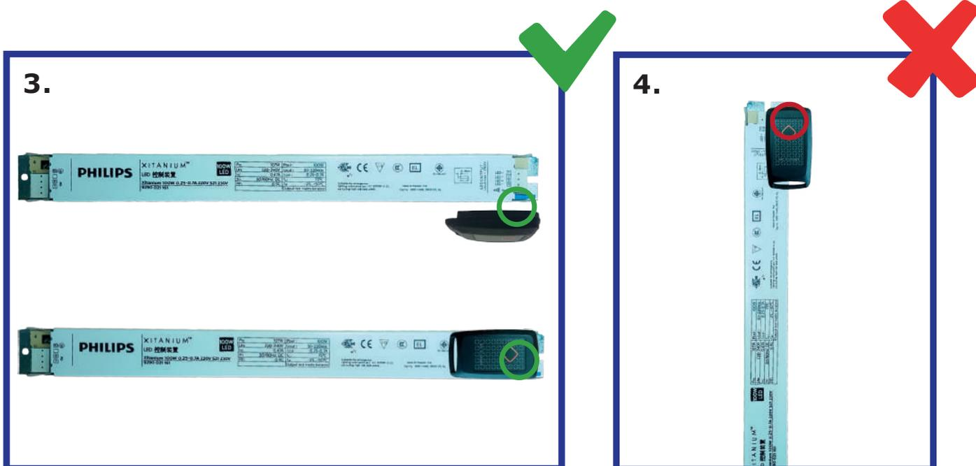
Per una lettura ottimale del driver LED, l'NFC Scanner deve essere posizionato in "edge reading" sopra l'area NFC del driver LED o lateralmente come mostrato in figura 3.
