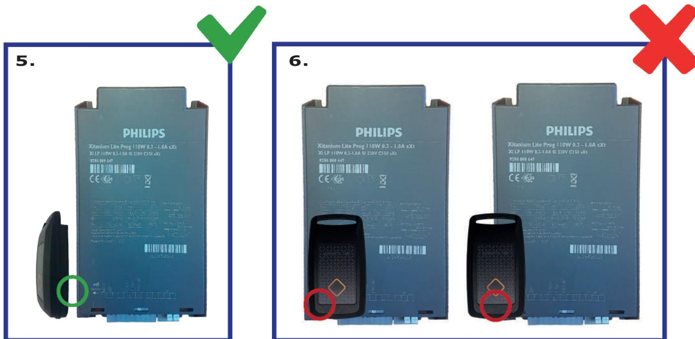
Per una lettura ottimale del driver LED, l'NFC Scanner deve essere posizionato lateralmente all'area NFC del driver LED come mostrato in **figura 5**.
