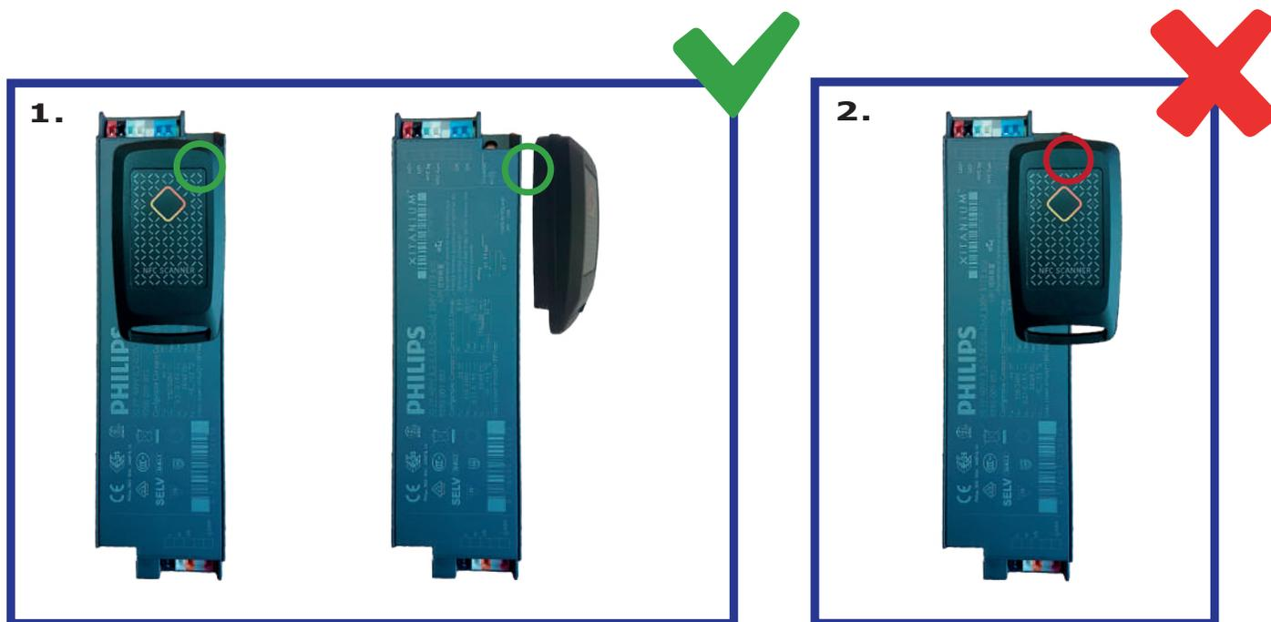
Per una lettura ottimale del driver LED, l'NFC Scanner deve essere posizionato in "edge reading" sopra l'area NFC del driver LED o lateralmente come mostrato in figura 1.
