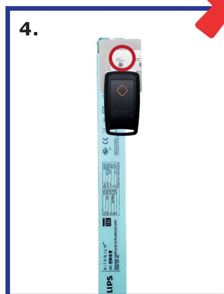
Per una lettura ottimale del driver, l'NFC Scanner deve essere posizionato in modo che il bordo dell'NFC Passive Repeater coincida con i bordi del driver LED, in corrispondenza con "Focus 2" riportato sull'etichetta apposta sull' NFC Passive Repeater. Oppure si posiziona di lato al driver LED. Vedere **figura 3**.
