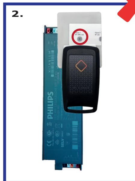
Per una lettura ottimale del driver, l'NFC Scanner deve essere posizionato in modo che il bordo dell'NFC Passive Repeater coincida con i bordi del driver LED, in corrispondenza con "Focus 2" riportato sull'etichetta apposta sull' NFC Passive Repeater. Oppure si posiziona di lato al driver LED. Vedere **figura 1**.
