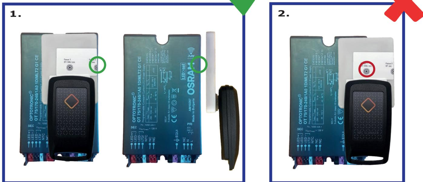
Per una lettura ottimale dei driver OT LED, l'NFC Scanner deve essere posizionato in modo che il bordo dell'NFC Passive Repeater coincida con i bordi del driver LED, in corrispondenza con "Focus 2" riportato sull'etichetta apposta sull' NFC Passive Repeater. Oppure si posiziona di lato al driver LED. Vedere **figura 1**.
