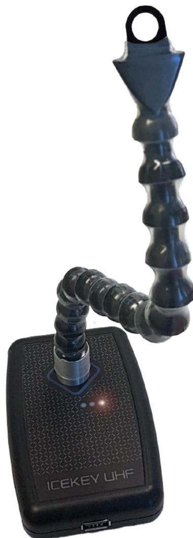
IceKey UHF Snake14 è un un lettore RFID fisso, di dimensioni contenute, dotato di antenna con supporto completamente snodabile, in grado di leggere e scrivere i tag UHF e di trasmettere i dati acquisiti a qualsiasi dispositivo dotato di interfaccia USB.
