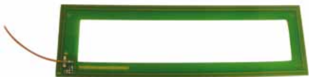
Antenna RFID personalizzata inserita all'interno del calamaio
